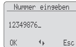
Geben Sie z. B. „12349876\_“ ein. Eingaben können Sie korrigieren, indem Sie mit den Pfeiltasten den Cursor auf eine Ziffer bewegen (welche dann blinkt). Mit der C-Taste wird die Ziffer links vom blinkenden Zeichen gelöscht. An dieser Stelle können Sie nun neue Ziffern einfügen. Drücken Sie am Ende der Eingabe **OK** um zur Namenseingabe weiterzuschalten.
