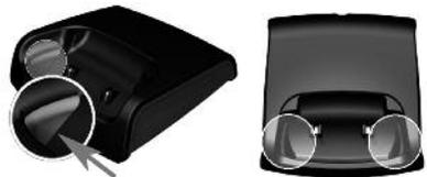
Die Führungen können Sie auch entfernen, indem Sie mit einem geeigneten Schraubendreher in die Langlöcher auf der Unterseite der Ladeschale drücken.
