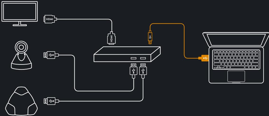
Das Einfache ist meist genial! So sind die Komponenten im Videopakete zusammengesetzt. Der Konftel OCC Hub sorgt wiederum dafür, dass die Lösung so einfach einzurichten und anzuwenden ist. Getreu seinem Namen bildet er das Zentrum der Paketlösungen. Er sorgt dafür, dass Konferenzkameras sowie Freisprech- und HDMI-Geräte One Cable Connection nutzen können.
