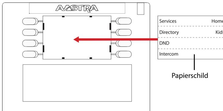
2. Setzen Sie die transparente Kunststoffabdeckung auf das Einlegeschild für Zielwahl, sodass sich die Halteungen über den entsprechenden Schlitzen befinden.
