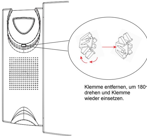
6. Hörer auf die Gabel legen, Beine der Klemme in das viereckige Loch am Hörer schieben. Dadurch bleibt der Hörer senkrecht in der Gabel, ohne dass er bei Wandmontage nach unten fällt.
