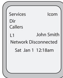
Überprüfen Sie, ob die Kabel am Telefon und an der Wandsteckdose fest angeschlossen sind. Das Telefon sollte automatisch feststellen, dass die Verbindung wieder hergestellt ist und zeigt dann kurz die Meldung "**Netzanschluss**". Wenn die Einstellungen des Telefons geändert worden sind, muss das Telefon neu gestartet werden.
