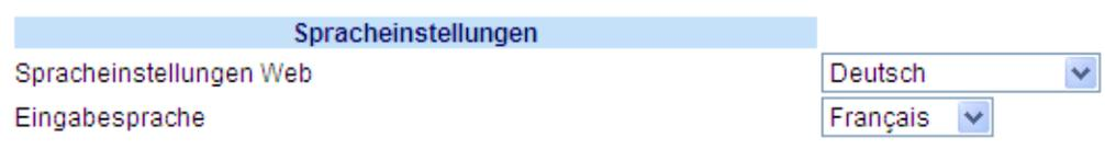
2. Wählen Sie eine Sprache aus dem Feld "**Eingabesprache**" aus. Durch Setzen dieser Option können Sie die Sprache für die Benutzerschnittstelle des IP-Telefons und die Aastra Web-Benutzerschnittstelle auswählen, die Sie zur Eingabe von Text und Sonderzeichen verwenden möchten. Gültige Werte sind:
